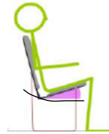
Şekil 1 Ofis koltuğu ve koltuğun yaslanma hareketi ile köşe kısmının takip ettiği eğrinin şematik gösterimi[4]
